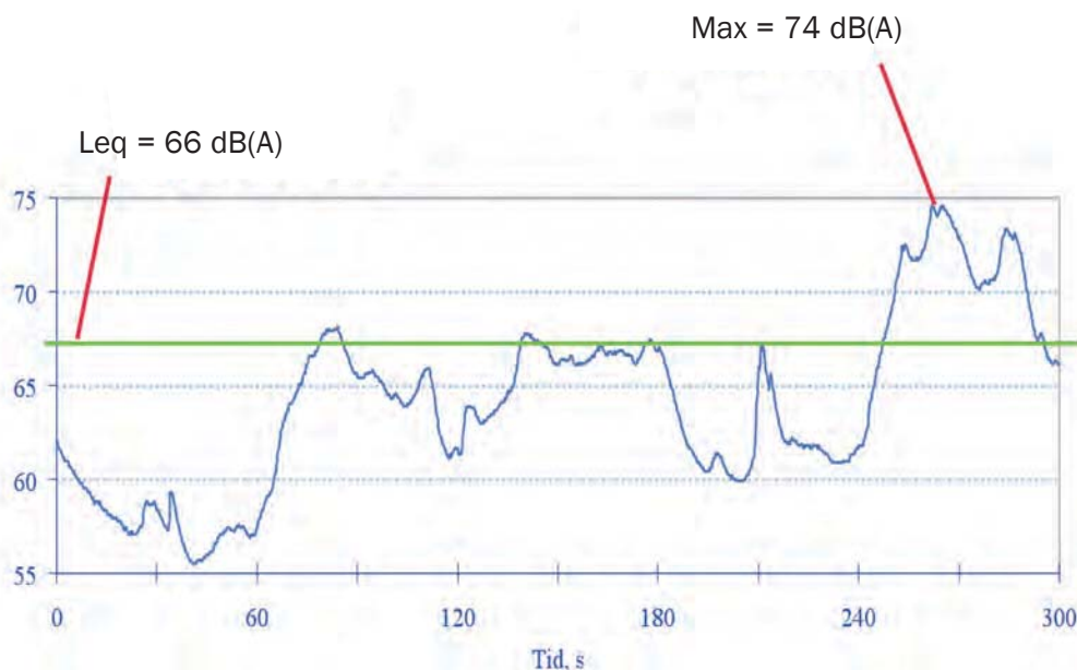
Ljudnivåns variation under 5 minuter på en innerstadsgata. Ekvivalentnivå 66 dB(A) maximalnivå 74 dB(A)
